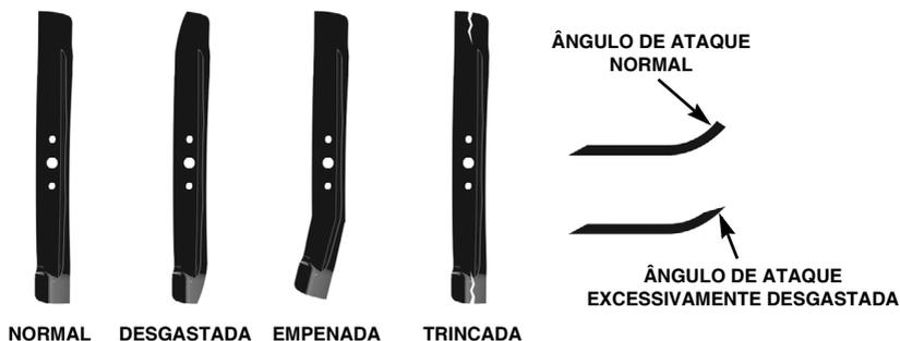
Se a lâmina estiver empenada, leve o cortador a um revendedor autorizado Honda para efetuar uma inspeção.
