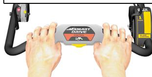
Solte o controle de Acionamento Inteligente (Smart Drive) para desacoplá-lo ao cortar a grama ao redor de árvores ou obstáculos. Empurre o cortador ao redor dos obstáculos para melhor controle direcional.
